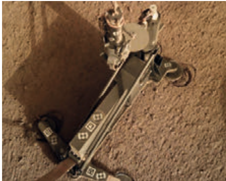
Das Gehäuse des HP 3 -Experiments hat sich beim Hämmern auf dem Marsboden leicht bewegt
