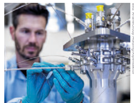
Der Triebwerksdemonstrator bei der Instrumentierung
