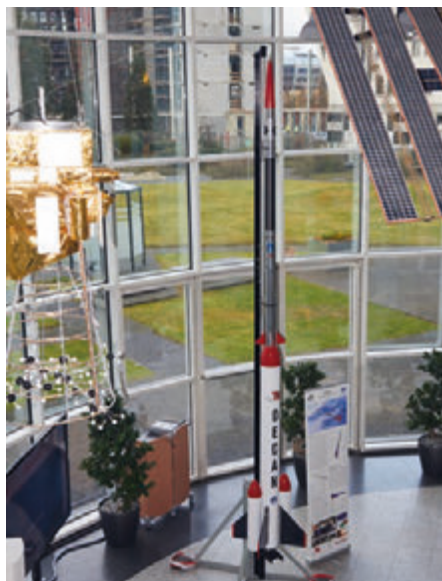
Die zweistufige DECAN-Rakete mit DECAN-AQUARIUS als Unterstufe und DECAN-SHARK als Oberstufe
