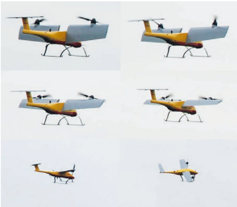
Abb. 1: Kippflügelfluggerät im Flug bei verschiedenen Flugeschwindigkeiten
