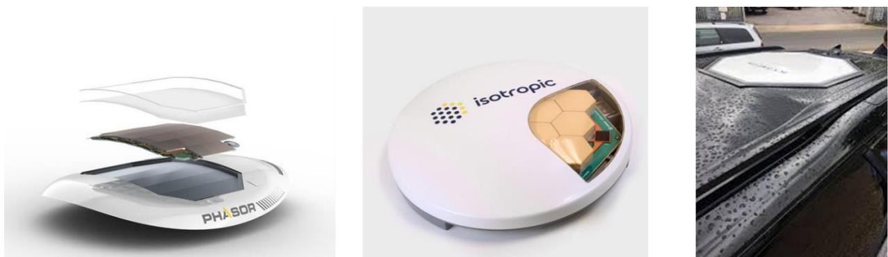
**Bild 88:** Beispiele von Hochgewinn Terminalkonfigurationen in Fahrzeugen
