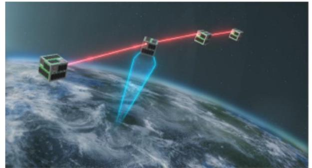
Bild 78: Intersatelliten – Kommunikation Projekt S-NET und mögliche Cluster-Konfigurationen (Quelle: TU Berlin, DLR)
