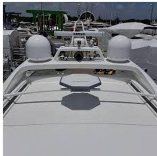
Bild 56: Mobile Hochgewinn - Antennen mit Strahlschwenkung (Quelle: Kymeta)
