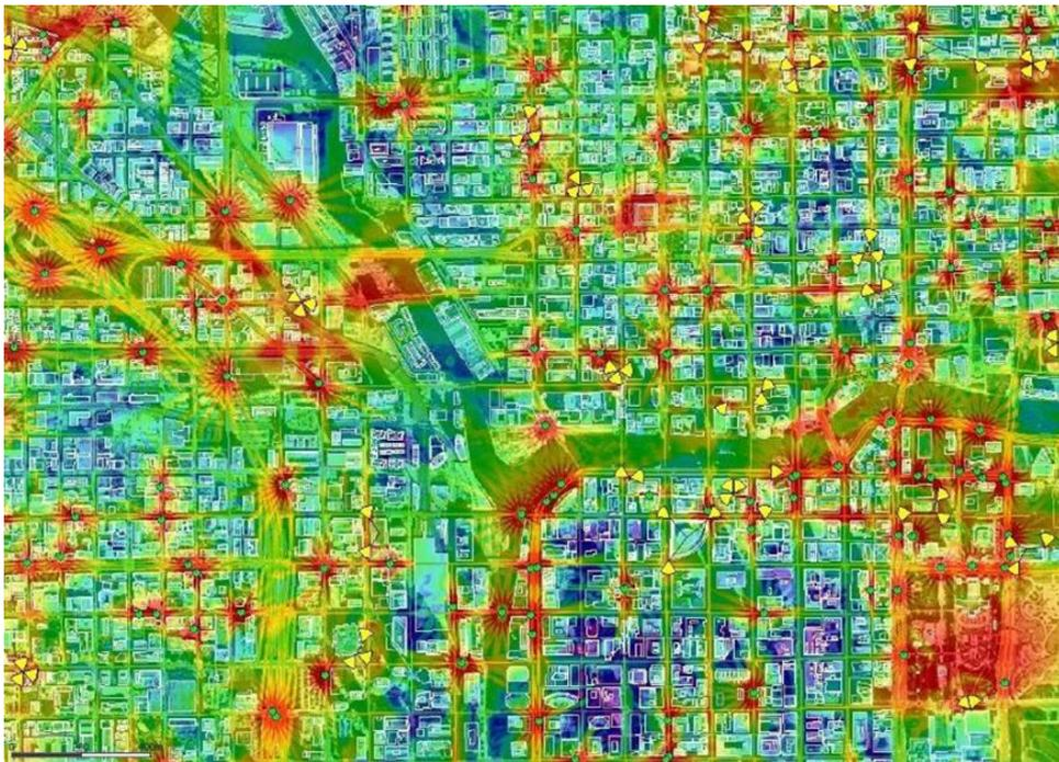
Bild 14: Feldstärkeverteilung in einer urbanen Umgebung bei 28 GHz (Quelle: Atoll)
