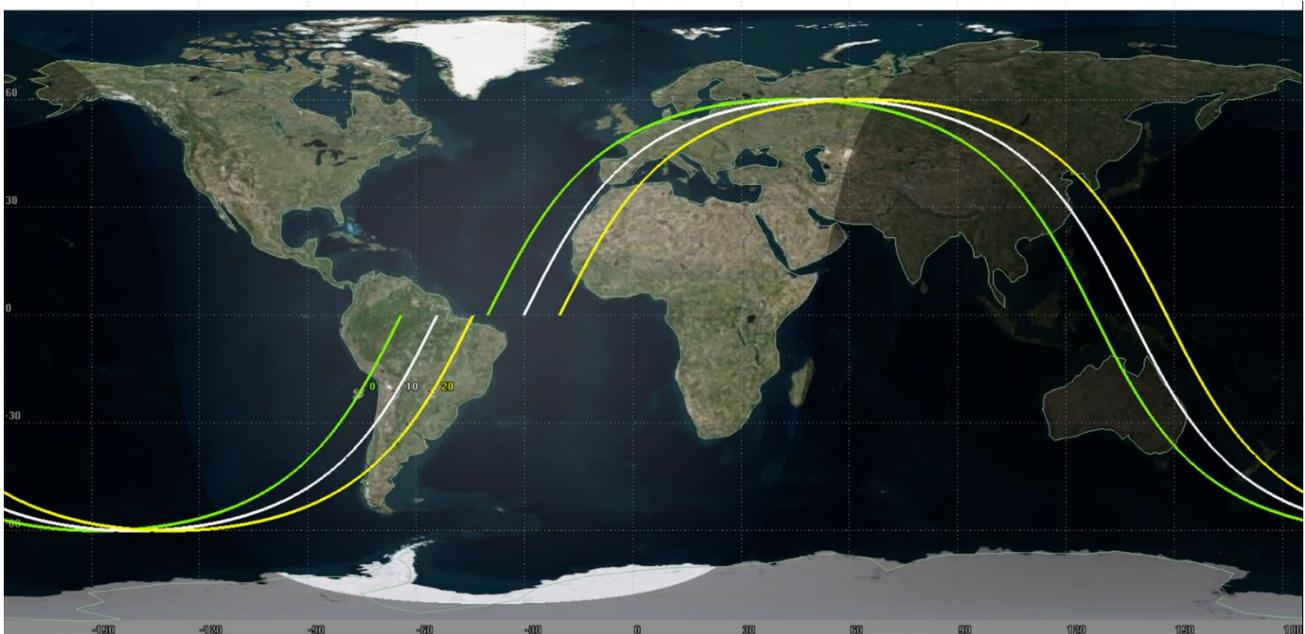
Bild 33: Bahnspur über der Zeit (3 Umläufe)
