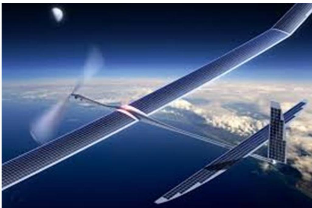
Bild 42: Autonome solarbetriebene Drohne (Google Solara 50)
